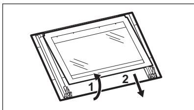
**Пункт 7** Вымойте стеклянные панели водой с мылом. Тщательно вытрите стеклянные панели. Не мойте стеклянные панели в посудомоечной машине.
